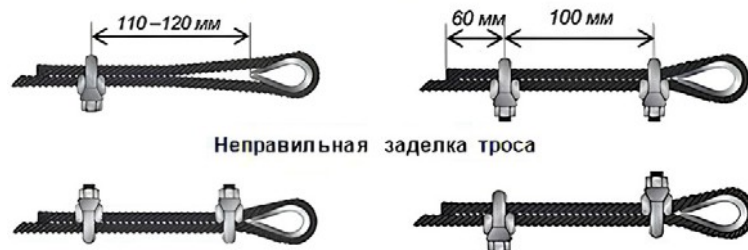
Рисунок 6 – Заделка троса
